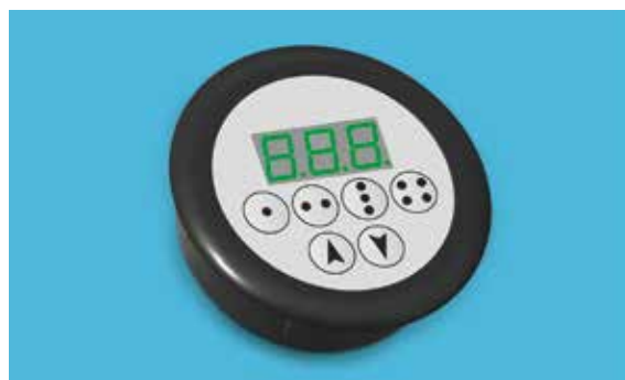
LD6R Bedienteil mit Auf- und Ab-Taste und 4 individuell belegbaren Speicher-tasten, digitale Höhenanzeige, Bohrungsdurchmesser 60 mm
